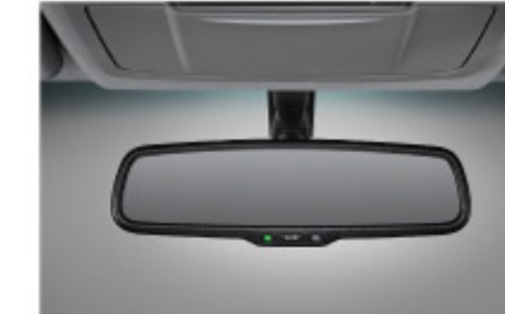
EC Mirror กระจกมองหลังลดแสงสะท้อนอัตโนมัติ จับที่ปลอดภัยมากขึ้นตอนกลางคืน
