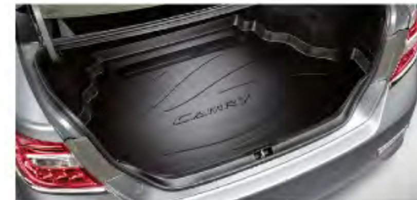
ถาดเก็บของท้ายรถ / Luggage Tray นิลตาควิสตุพลาสติก LDPE (Low Density Polyethylene) ทนต่ออุณหภูมิต่ำ-สูงได้ดี นั้มีแรม ทนทาน พื้นถาดออกแบบพิเศษ ช่วยลดการสั่นโกลของสินการ-
