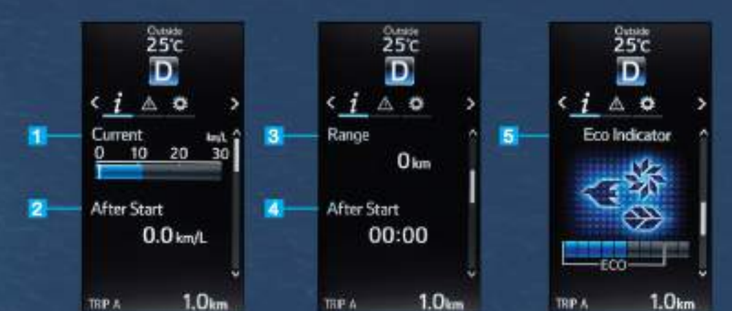
จอแสดงผลการขับขี่แบบสี (Color MID) ให้ทุกรายละเอียดคมชัด โดดเด่นกว่าที่เคย 1. อัตราการสิ้นเปลืองน้ำมันในขณะขับขี่ (Current) 2. อัตราการสิ้นเปลืองน้ำมันโดยเฉลี่ย (Average Consumption After Start) 3. ระยะทางที่สามารถขับขี่ได้ (Cruising Range) 4. ระยะเวลาในการขับขี่ (Elapsed Time After Start) 5. จอแสดงผลการขับขี่แบบประหยัด (Eco Indicator)
