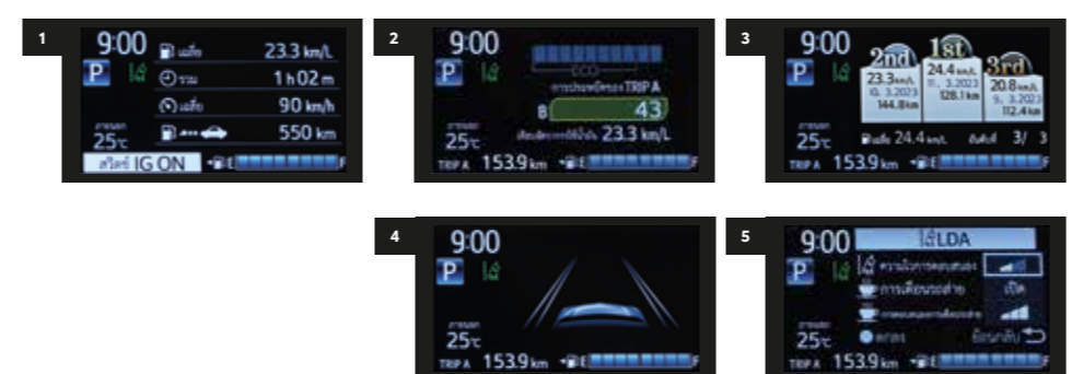
มาตรวัดแบบเรืองแสง พร้อมจอแสดงผลข้อมูลการขับขี่แบบจอสี่เหลี่ยม TFT ขนาด 4.2 นิ้ว
