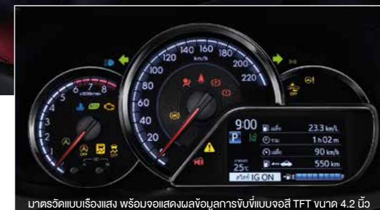
มาตรวัดแบบเรืองแสง พร้อมจอแสดงผลข้อมูลการขับขี่แบบจอสี่เหลี่ยม TFT ขนาด 4.2 นิ้ว
